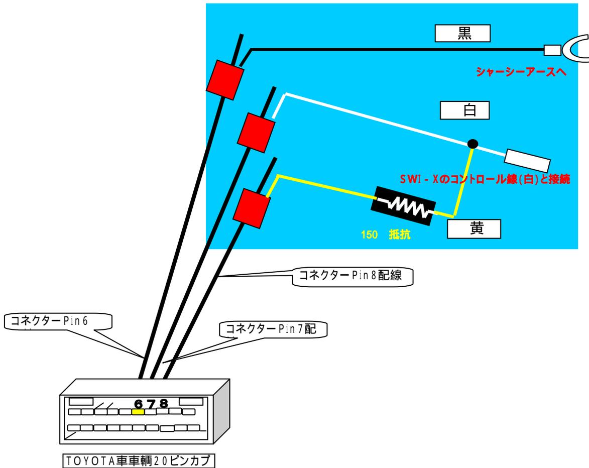
TOYOTA車車輛20ピンカプラーのNO. 6, 7, 8 の各配線に、当配線キットを接続します。
