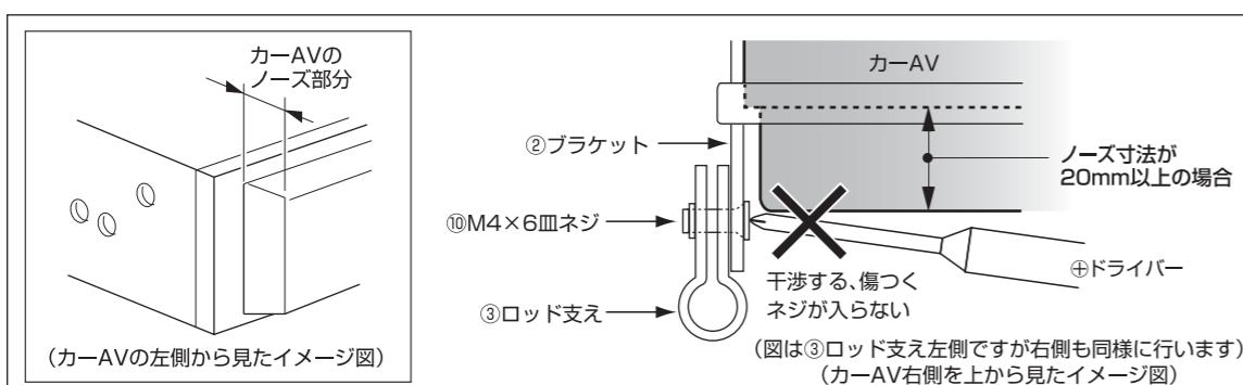
※ノーズ寸法が20mm以上あるフラップ式カーアビーナーAVの場合、フラップを開いた状態でロッド支え取付周辺へ干渉しない製品は取付けできます。
