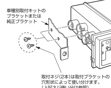
図は左側への取付けですが、右側も同様に行います。
